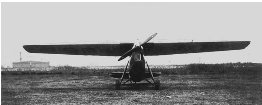
Fabryczne zdjęcie samolotu RWD-5. Sylwetka idealnie z przodu, możliwe do określenia: rozstaw podwozia, wznios płata oraz średnica śmigła (z uwzględnieniem skrótu perspektywicznego – ok. 1,9 m)
